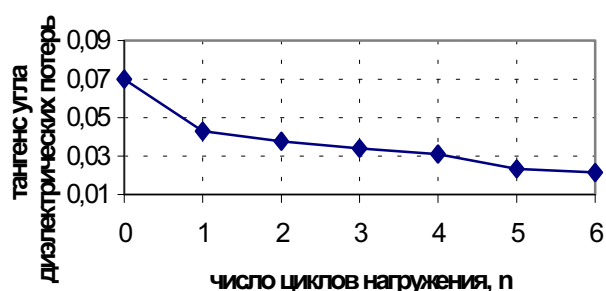
Рис. 3. б - Зависимость тангенса угла диэлектрических потерь от числа циклов нагружения; алевролит, ш. 3. - Донбасская, гл. 480 м, "кубик"
